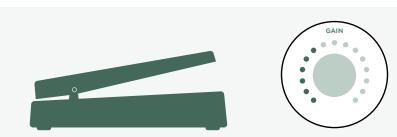
Nun bewegen Sie das Pedal in die Zehenstellung. Anschließend drehen Sie dann den **GAIN**-Regler auf den gewünschten Grad für den Morph-Sound.
